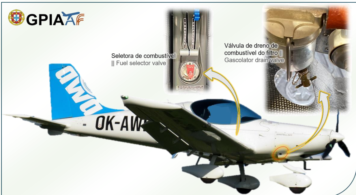
Detalhe da válvula seletora e de dreno do filtro (vista interna)
