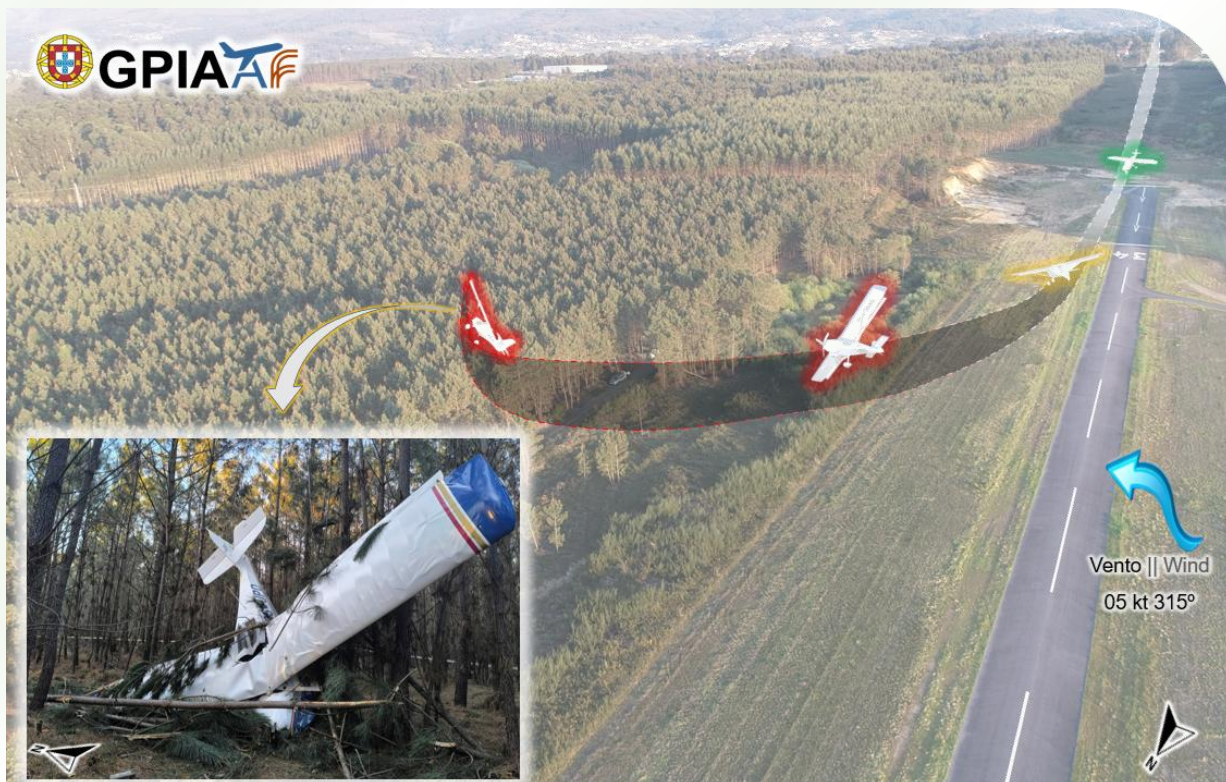
Posição final da aeronave e estimativa da trajetória com base em testemunhos e evidências da colisão
