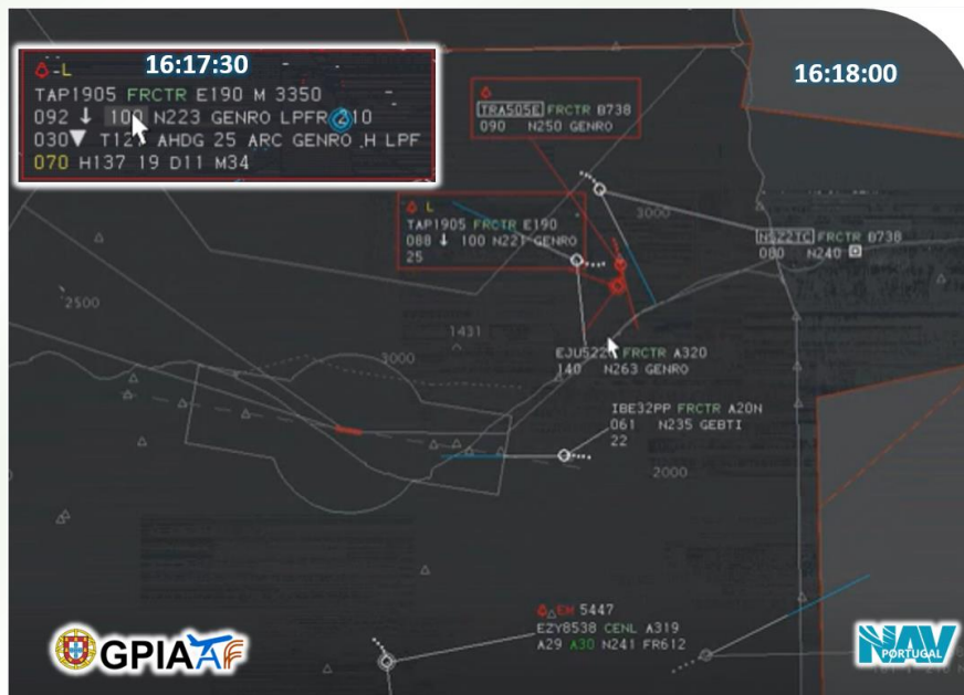
Figura 3 || Momento quando o controlador se apercebeu da falta de separação entre as aeronaves
