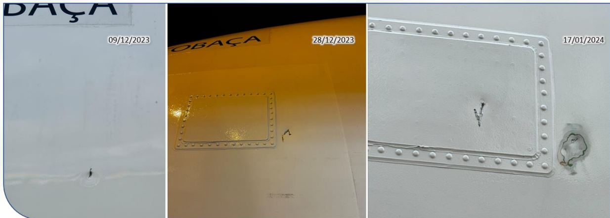
Figura 1 || Figure 1 Registo dos danos na mesma área (CS-TAX) || A record of damage in the same area (CS-TAX)
