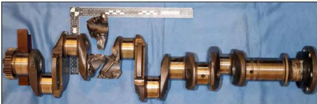
Figura 1 || Figure 1 Vista geral da cambota danificada || General views of failed crankshaft
